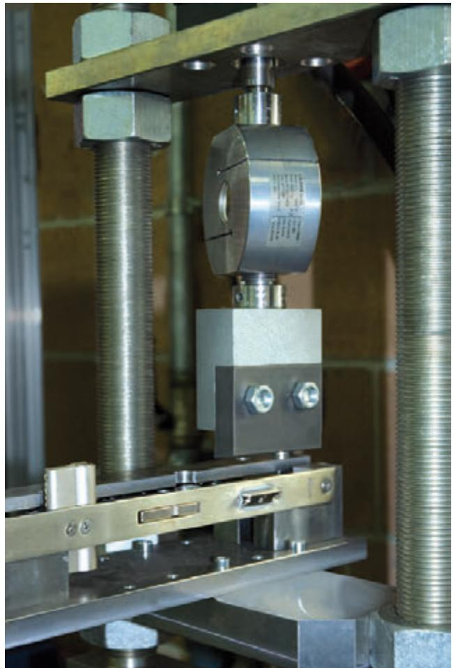
E' conforme alla norma europea UNI EN 12209:2003 che specifica i requisiti e i metodi di prova per la resistenza, sicurezza, durabilità e funzionalità di serrature azionate meccanicamente e delle loro contropiastre per uso sulle porte, porte finestre e porte d'ingresso degli edifici.
